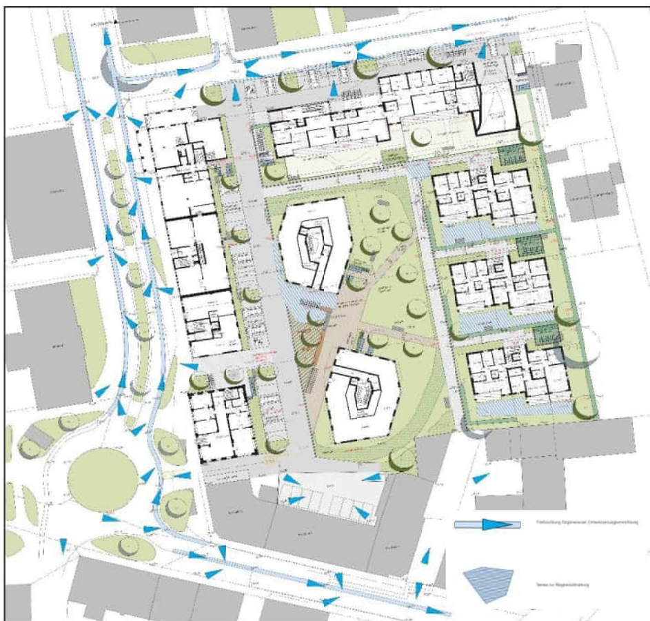
Abbildung 4: Voraussichtliche Fließrichtung des Regenwassers (Plan: FG Architekten 2023)
