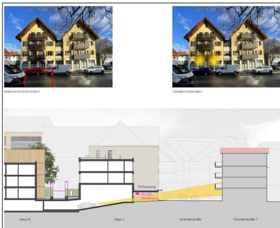
Abbildung 8: Auszug aus der geometrischen Untersuchung der Blendwirkung ggü. der Tiefgaragenausfahrt; hier Position 1 mit höchstem Lichtkegel; (Plan: FG Architekten 2023)
