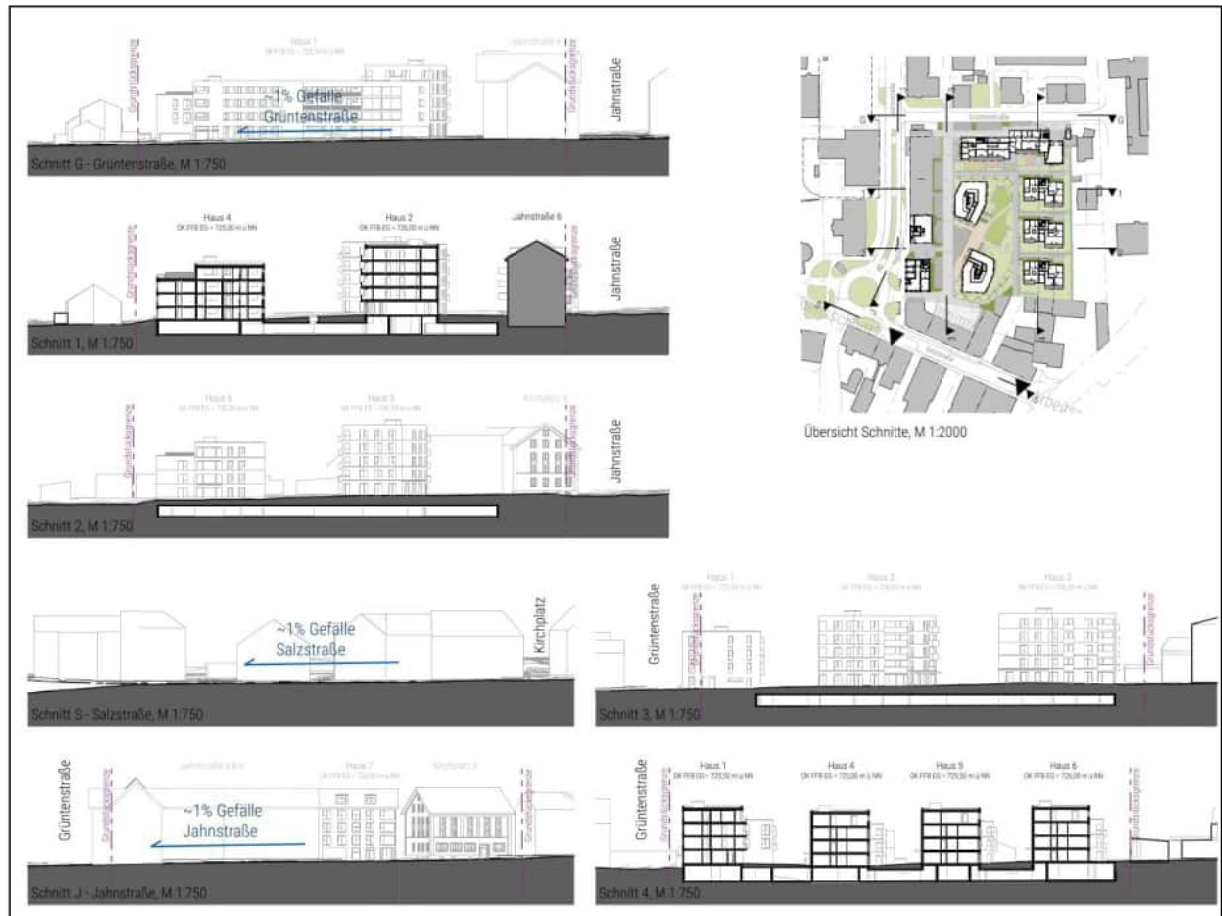
Abbildung 5: Geländeschnitte mit geplanten Regenwassersenkten (Plan: FG Architekten 2023)
