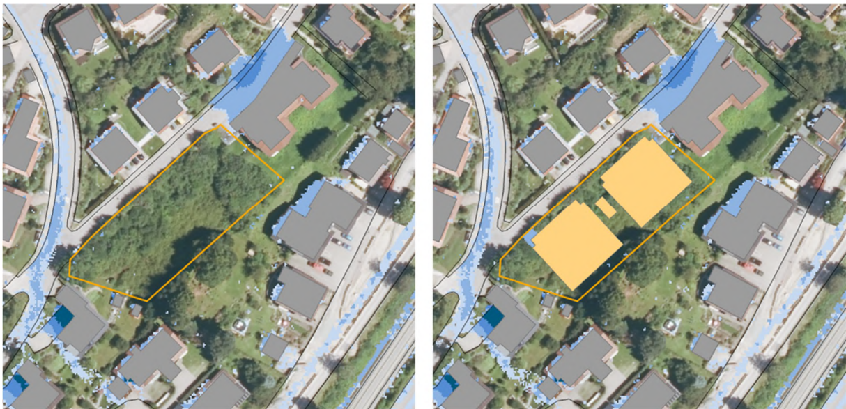
Abbildung 2: Maximale Überflutungstiefen im Bestand (links) und in der Planung (rechts), bei einem 100-jährlichen Regenereignis
