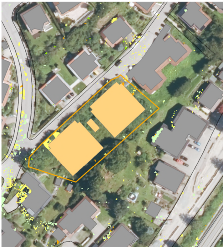
Abbildung 3: Differenz der maximalen Überflutungstiefen bei einem 100-jährlichen Regenereignis mit/ohne Plangebiet
